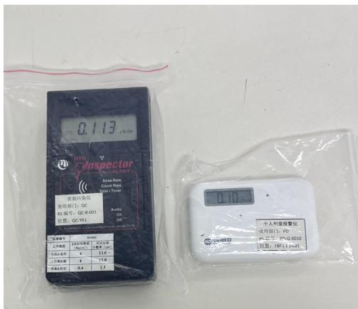
表面污染检测仪和个人剂量报警仪
